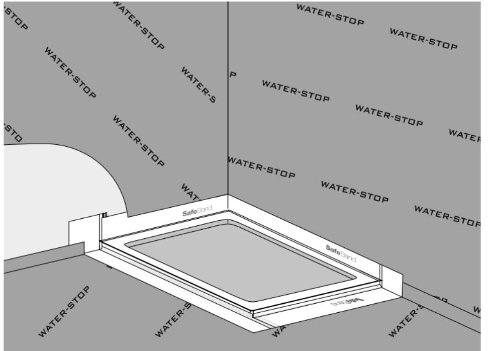
Una vez instalado el plato de ducha o bañera en su posición definitiva y pegar **SafeBand** a las paredes y al suelo con cemento cola tipo C2.
