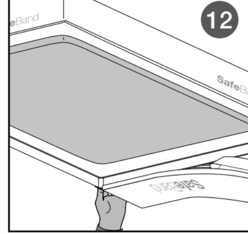
La banda de los lados que van al suelo debe remontar en las paredes y conectarse con la banda de los otros lados. Retire unos 20 cm de la tira más ancha de papel y empiece a pegar desde una esquina en la cara inferior del plato o bañera. El ala estrecha, aún con su papel, debe quedar en el lateral.
